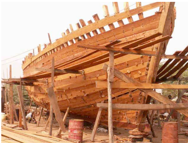
Ξύλινο σκάφος υπο κατασκευή
